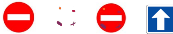
Figure 16 – Attaque sur l'entrée (à gauche l'entrée, une perturbation avec des autocollants au milieu, l'entrée modifiée à droite et finalement le panneau reconnu)
